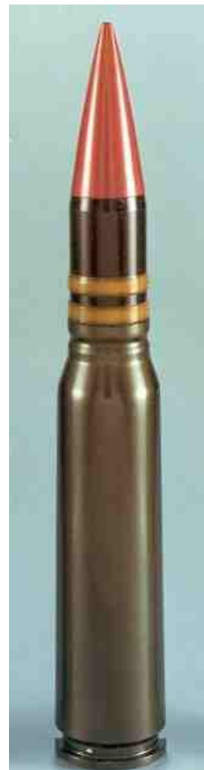
Fotos: (links) Mitarbeiterin des Institutes für Pflanzenernährung und Bodenkunde der FAL in Schutzkleidung bei der Arbeit mit Uran-kontaminierten Böden; (rechts) Maschinengewehr-Munition (173*30mm) mit DU-Penetrator (300g)
